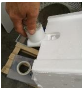
5 Monteer het aansluitstuk voor de slang bij de invliegopening.
